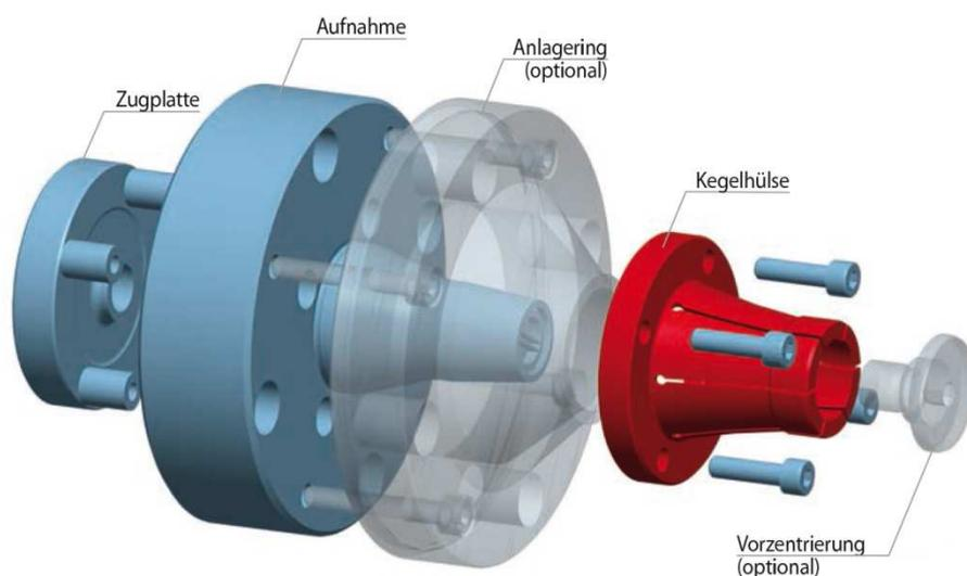
Der Kegelhülsen-Flanschdorn HKDF setzt sich aus Zugplatte, Aufnahme und Kegelhülse zusammen. Optional ist ein planparallel geschliffener Anlagering und eine Vorzentrierung erhältlich. Der Kegelhülsen-Flanschdorn HKDF wird mit der Aufnahme an der Maschine montiert. Betätigt wird das Spannzeug durch die Zugplatte, die mit der Kraftspanneinrichtung der Maschine verbunden ist.
