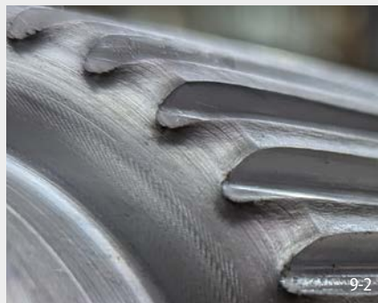
Detail-Aufnahme eines kaltgewalzten Zahnwellenzapfens
