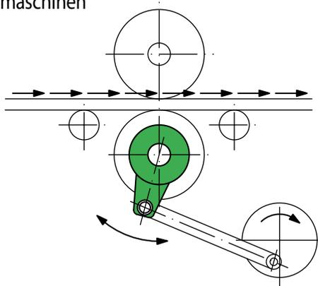
Der Vorschubfreilauf erzeugt schrittweise Transportvorschübe in Textil- und Druckmaschinen.
