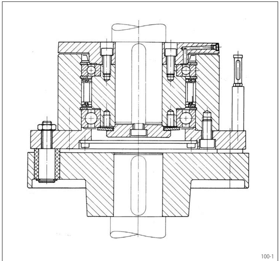
Überholfreilauf mit Klemmstückabhebung Z in wartungsfreier Sonderausführung. Eine Schmierung der Klemmstücke in dem Überholfreilauf ist wegen der gegebenen hohen Leerlaufdrehzahl des Außenringes nicht erforderlich, da die Klemmstücke unter Einwirkung der Fliehkraft vom stillstehenden Innenring abheben und daher verschleißfrei arbeiten.
