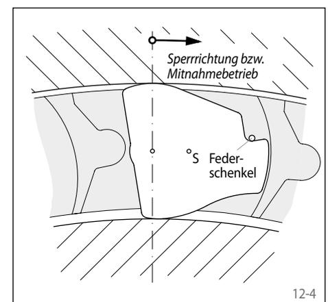
der Freilauf arbeitet berührungslos. Sinkt die Außenring-Drehzahl soweit ab, dass die Wirkung der Fliehkraft auf das Klemmstück kleiner wird als die Anfederungskraft  $F_F$ , so legt sich das Klemmstück wieder an den Innenring an,
