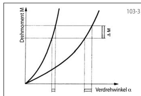
M zum Beispiel um den Wert  $\Delta M$ , so ist die Auswirkung auf den Verdrehwinkel  $\alpha$  bei dem Freilauf mit flacher Kennlinie viel größer als bei dem Freilauf mit steiler Kennlinie. In Vorschubantrieben wird man somit immer Freiläufe mit möglichst steiler Kennlinie wählen.
