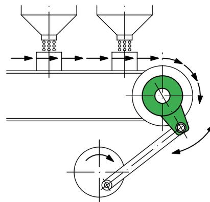
Der Vorschubfreilauf wird in Verpackungsmaschinen und Abfüllanlagen zum schrittweisen Vorschub eingesetzt.
