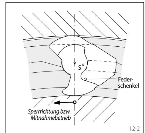
Dabei ergibt sich der Spalt  $a$  zwischen Klemmstück und Außenringlaufbahn; der Freilauf arbeitet berührungslos. Sinkt die Innenring-Drehzahl soweit ab, dass die Wirkung der Fliehkraft auf das Klemmstück kleiner wird als die
