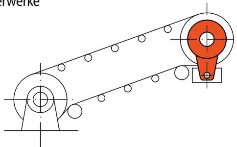
Die Rücklaufsperr verhindert, dass das Fördergut bei Stromausfall oder abgeschaltetem Motor zurück läuft.
