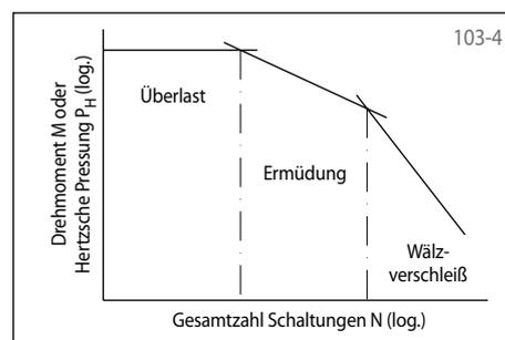
gen an den Klemmkontakten abhängig. In Bild 103-4 ist schematisch gezeigt, dass drei Bereiche zu unterscheiden sind: Überlast, Ermüdung und Wälzverschleiß. Vorschubfreiläufe sind so auszuwählen, dass sie im Bereich des Wälzverschleißes arbeiten. Dann sind Gesamtzahlen an Schaltungen über  $1 \times 10^8$  erreichbar. Dies entspricht bei einer Schaltfrequenz von 100 Schaltungen/min einer Lebensdauer von ca. 16 666 h.
