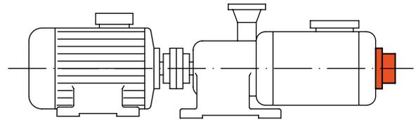
Die Rücklaufsperr verhindert ein Rückwärtslaufen unter dem Druck des Fördermediums nach dem Abschalten des Motors.
