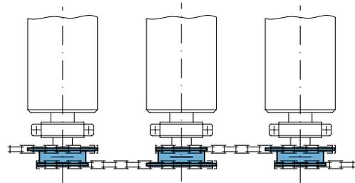
Der Überholfreilauf bewirkt, dass das Fördergut schneller als es der Drehzahl des Antriebs entspricht über den Rollgang geschoben oder gezogen werden kann.
