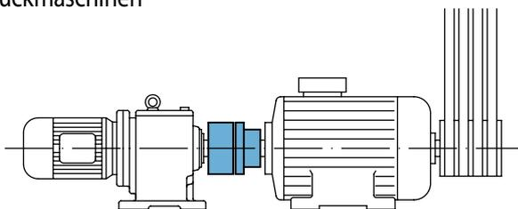
Der Überholfreilauf trennt in Textil- und Druckmaschinen den zum Einrichten erforderlichen Kriechgangtrieb vom Hauptantrieb.
