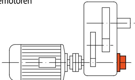
Die Rücklaufsperr verhindert im Antrieb von Förderanlagen ein Rücklaufen bei Stromausfall oder nach dem Abschalten des Motors.
