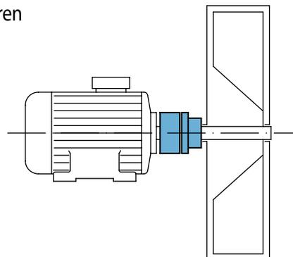
Der Überholfreilauf verhindert beim Abschalten von Gebläsen oder Ventilatoren, dass deren Schwungmasse den Antrieb mitzieht.
