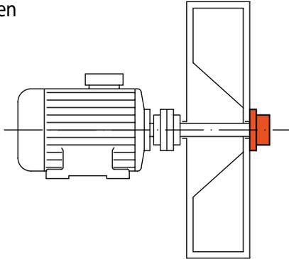
Die Rücklaufsperr verhindert ein Rückwärtslaufen unter dem Druck des Fördermediums nach dem Abschalten des Motors.
